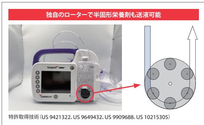
図1 独自のローター機構を有する高粘度対応の経腸栄養ポンプ
